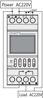
Схема подключения для управления однофазной нагрузкой.
